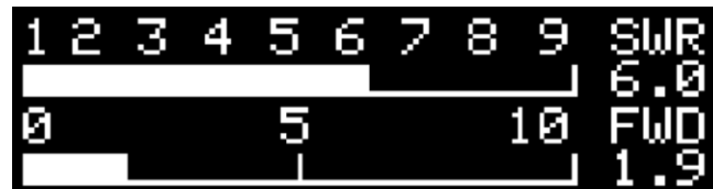
电台功率低于 10W 时、驻波超过 3 时显示界面
